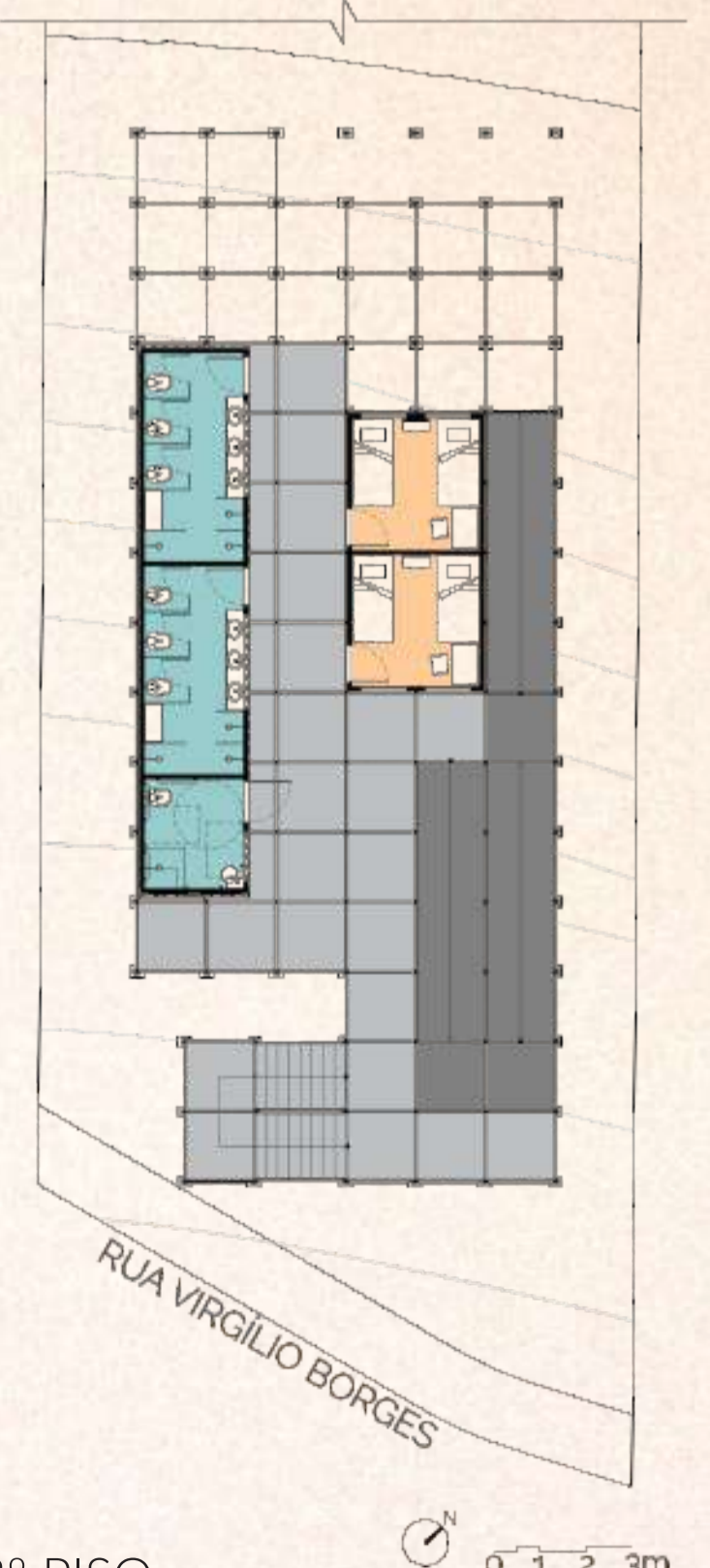
3º PISO Nível 6,00m Capacidade máxima de pessoas por quartos do abrigo - até 4 pessoas
